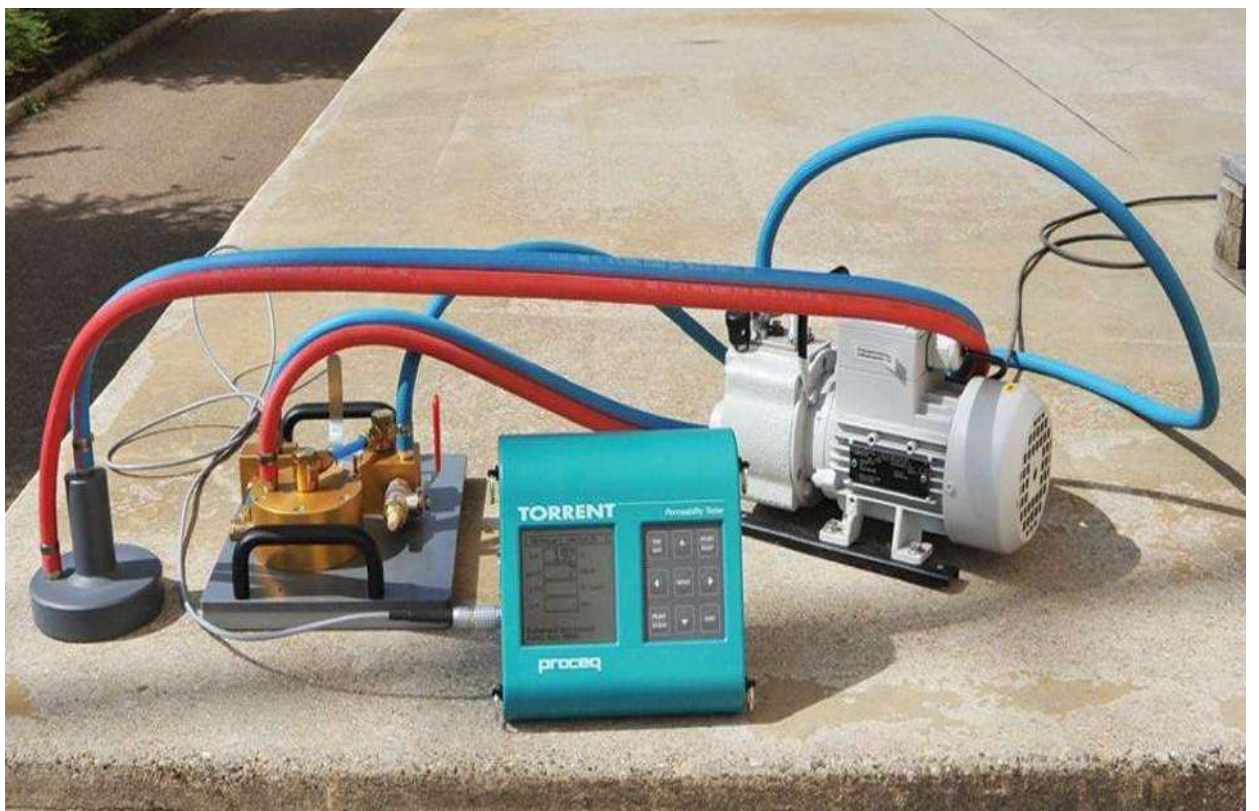
Máy thử khả năng chống thấm bê tông tại công trường
