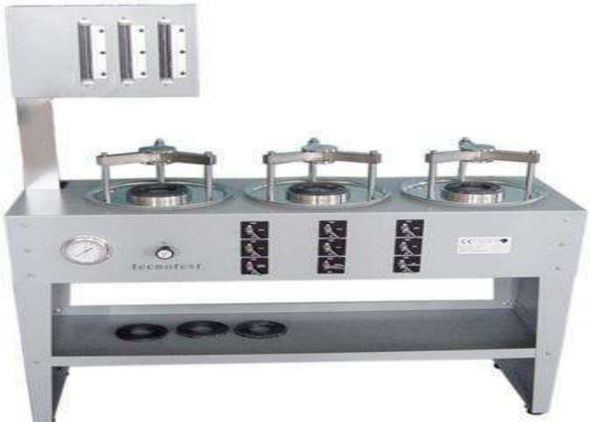
Thiết bị kiểm tra độ chống thấm nước của bê tông
