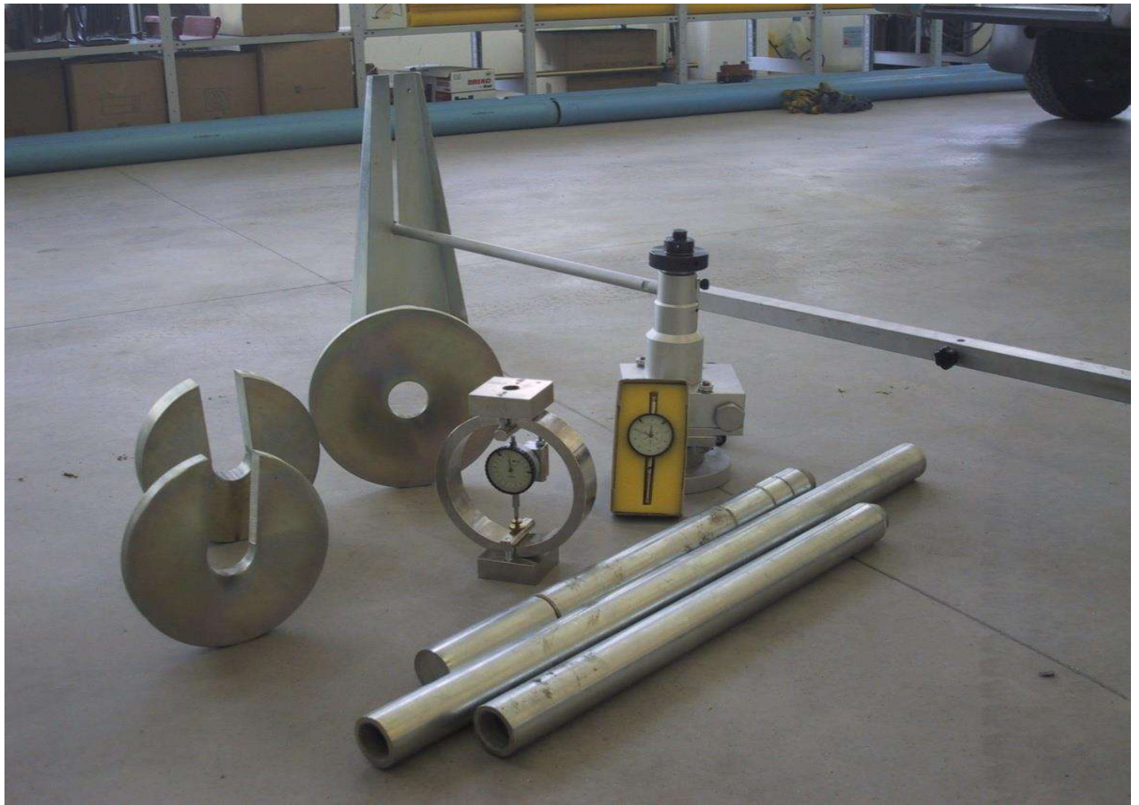
Thiết bị kiểm tra CBR hiện trường
